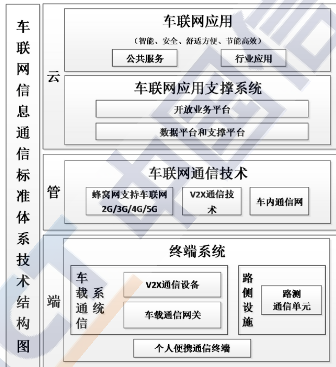
图 2-9 车联网产业（信息通信）标准体系技术结构图
